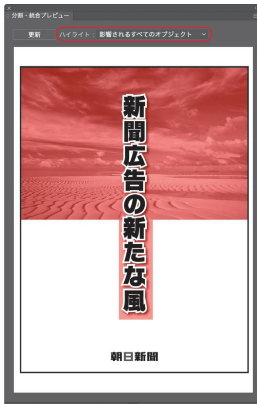
「分割・統合プレビュー」の「影響されるすべてのオブジェクト」で透明オブジェクトと影響を受ける箇所があるかを確認する。
